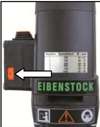
Das Gerät ist mit einem Stellrad versehen über das die Drehzahl zwischen 250 und 1000 min<sup>-1</sup> stufenlos geregelt werden kann.
