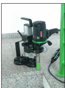
Bohren Sie am Anfang sehr langsam, da die Krone nur mit einem Bruchteil ihrer Schnittfläche ins Material greift. Wenn Sie zu schnell oder mit einem zu hohen Druck bohren kann die Krone verlaufen.
