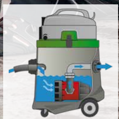
EPS 50 Funktionsschema
