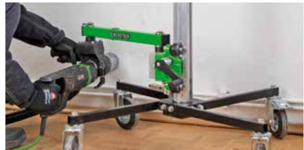
Serienbohrungen beim Dosen senken
