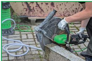
**Integrierte Wasserzuführung mit Durchflussregler**
